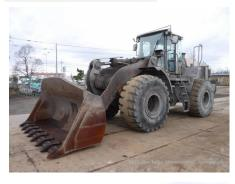
・ラジエター前カバーロック不良、エンジンカバー変形。
